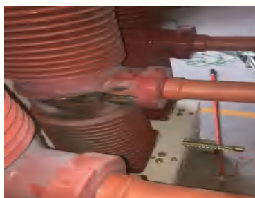
图4 #2 电抗器故障点
