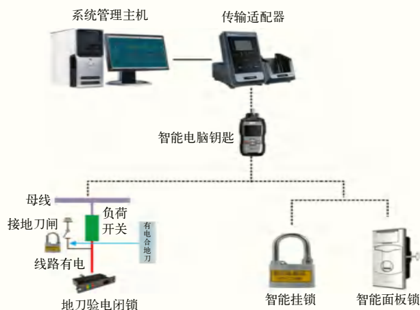
图2 环网柜接地开关防误操作装置
