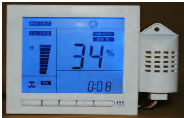
图8 环网柜除湿装置除湿效果图
