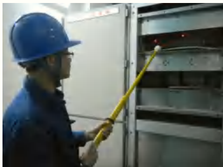
图4 互感器极性检测仪进行“高度”测试
