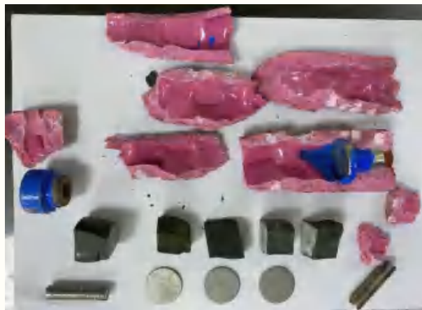
图4 5号避雷器解体检查情况
