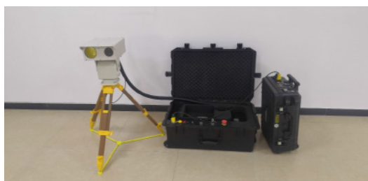
图2 激光除异物设备组装图
