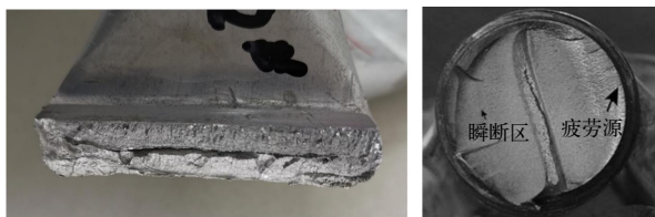
图4 3号导线引流线夹(2#)断口照片
