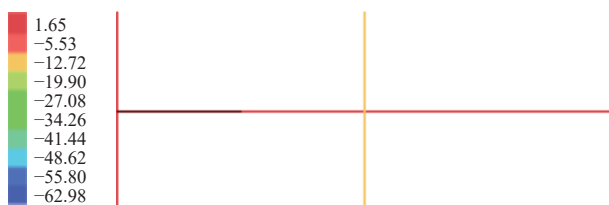
图12 组合 10: 1.2 \times 重力荷载代表值效应 +1.3 \times X向地震 -0.5 \times 竖向地震轴力云图 (kN)
