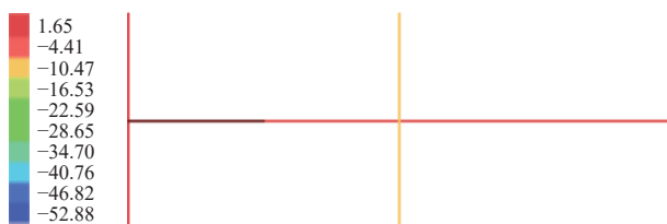
图14 组合 32: 1 \times 重力荷载代表值效应 +1.3 \times X向地震 -0.5 \times 竖向地震轴力云图 (kN)
