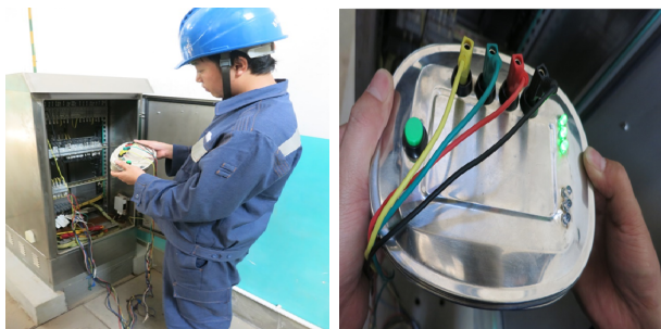
图4 智能无线互感器极性测试仪实际使用图
