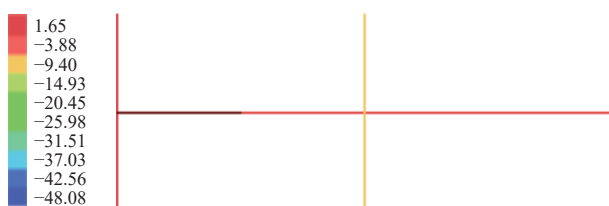
图13 组合 31: 1 \times 重力荷载代表值效应 +1.3 \times X向地震 +0.5 \times 竖向地震轴力云图 (kN)
