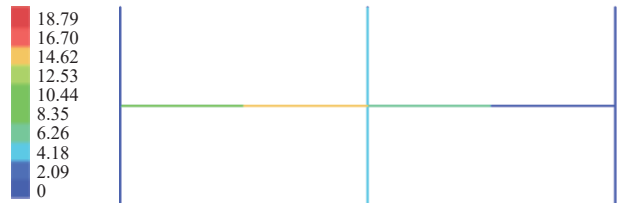
图7 恒荷载（含自重）工况位移云图（mm）
