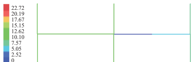
图9 Y向地震工况位移云图（mm）
