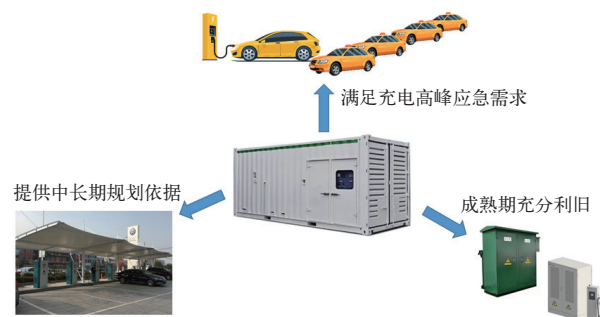
图2 集装箱式移动充电站系统运行方式
