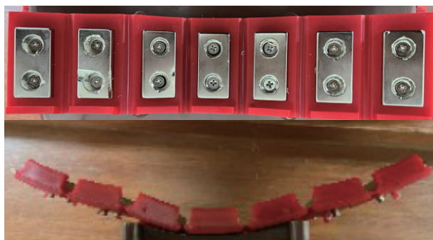
图2 异形底座安装模块结构
