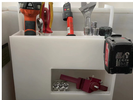
图 5 取放盒在绝缘斗臂车内应用图
