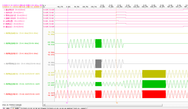
图2 110 kV 某 135 线路第一次发生 B 相接地故障波形
