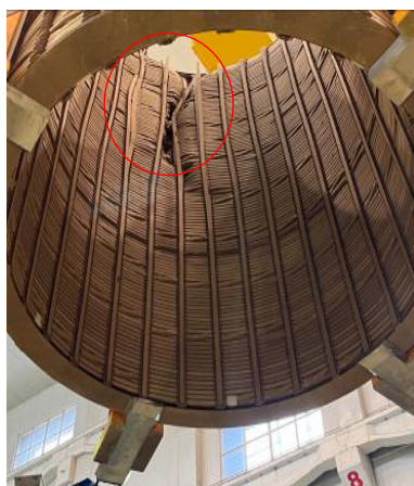
图 8 A 相中压绕组撑条分层情况
