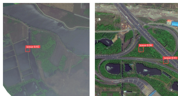
图6 在不同天气下杆塔目标检测结果示例
