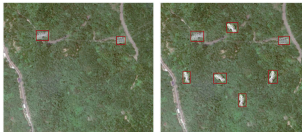
图 3 杆塔目标 Mosaic 处理示意图 (左原图, 右处理图)
