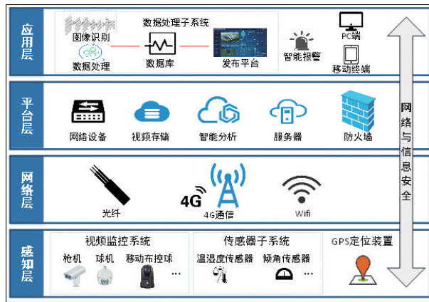
图1 智慧工地系统架构图
