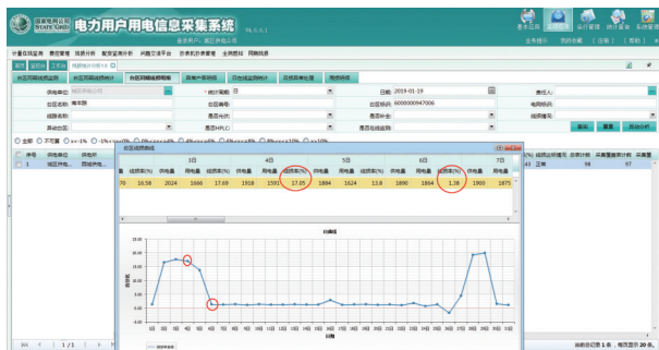
图3 南丰路柱变治理后线损指标走势图
