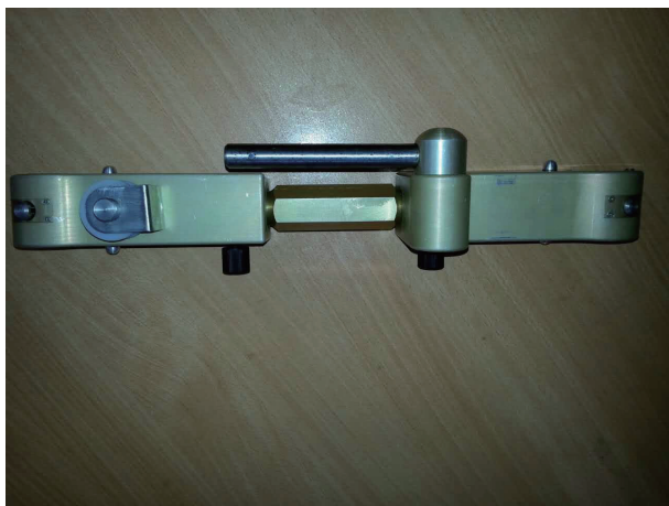
图2 双分裂导线更换或加装间隔棒专用工具实物图
