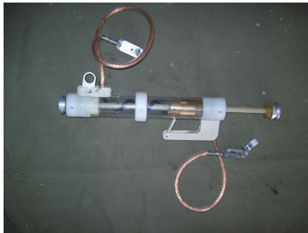
图3 加工完成的快分快合消弧开关
