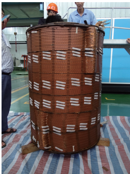
图7 中压C相线圈变形
