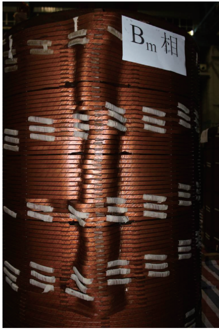
图6 中压B相线圈变形
