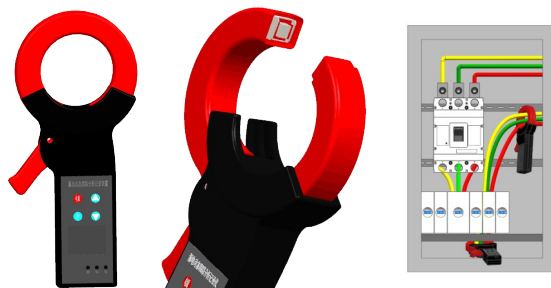
图2 装置外观设计图及使用构想图
