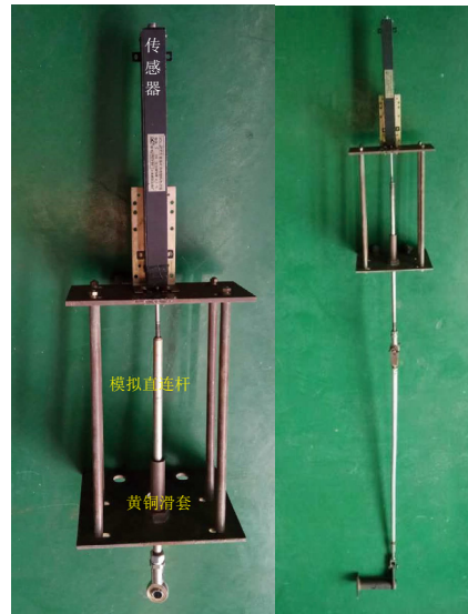
图8 传感器安装支架及整体测试支架
