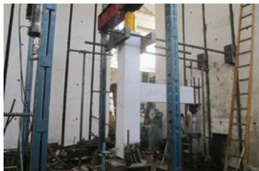
(b)新型装配式梁柱边节点试验
