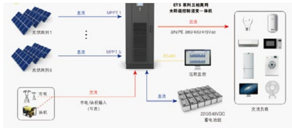
图1 离网光伏电站配置图
