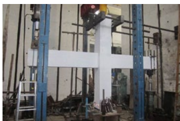
(a)新型装配式梁柱中节点试验
