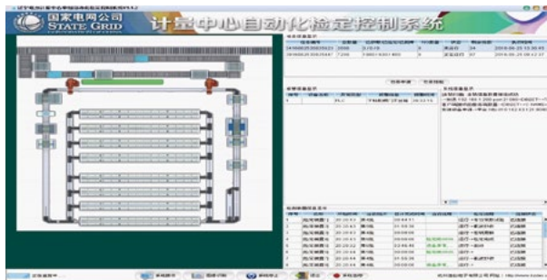
图3 单相电能表自动化流水线检定系统
