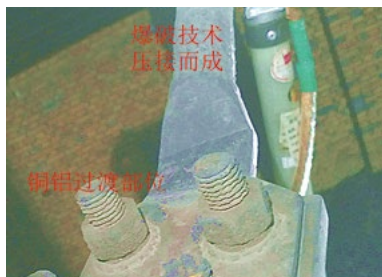
图1 采用爆破技术压接的铜铝过渡线夹
