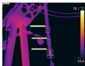
(d) 东南侧拍摄 最高温度 35.5 °C, 温差 10.5 K
